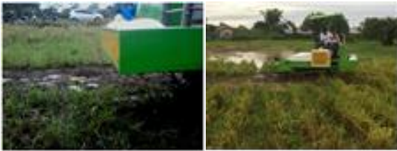
Gambar 7 Pengujian unit dekomposer pada prototipe rotavator
