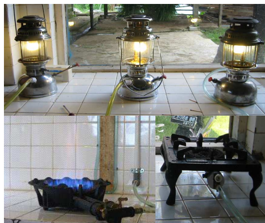
Gambar 5. Penggunaan biogas untuk penerangan dan kompor gas
