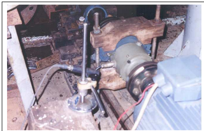
Lampiran 5. Slip ring torque-meter untuk mengukur torsi pada poros pompa.
