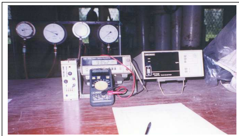
lampiran 3. Instrumentasi untuk mengukur tekanan, hisapan, rpm dan torsi poros pompa.
