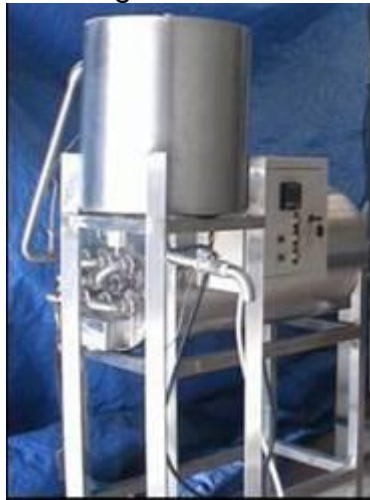
Gambar 6. Mesin pasteurisasi/ sterilisasi puree dan juice buah
