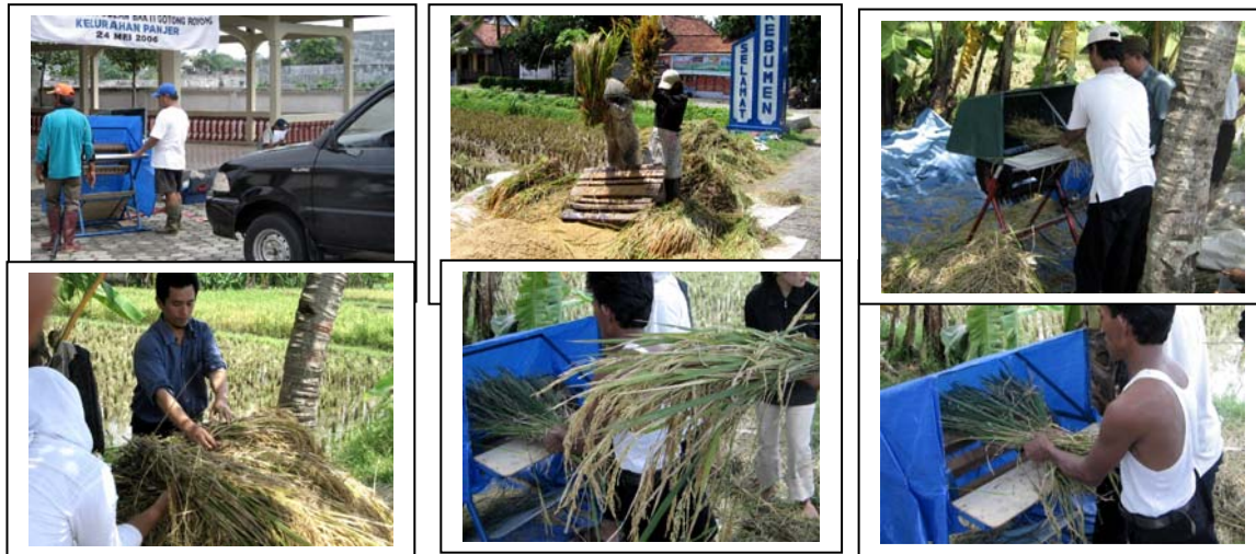
Gambar 4 : Evaluasi kinerja Lapang Stripper Raspbar di Kebumen
