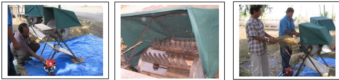
Gambar 3 : Evaluasi kinerja Laboratorium Thresher Stripping Raspbar
