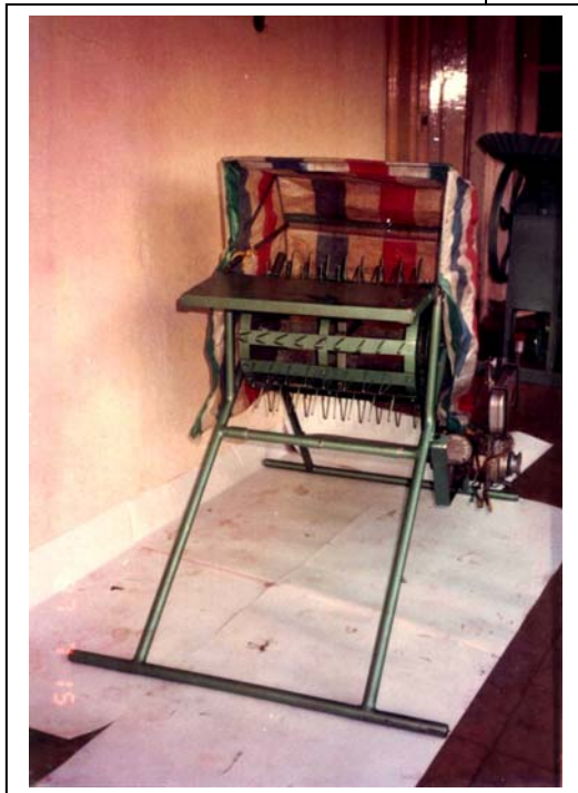
Gambar 1 c : Thresher Lipat pada posisi Sedang tidak dilipat (siap beroperasi)
