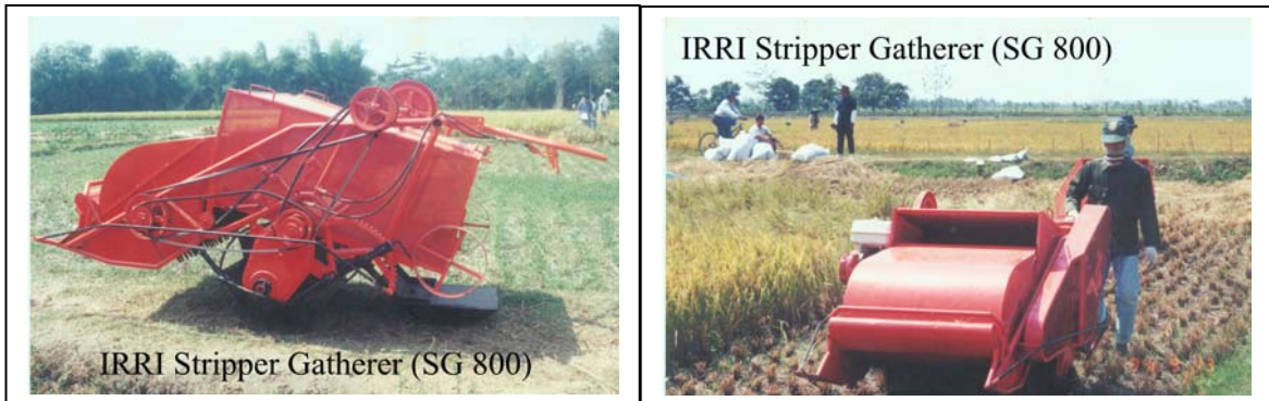
Gambar 1. Stripper Harvester IRRI-SG 800 yg telah difabrikasi oleh pengrajin alsintan di Surabaya sebagai hasil kerjasama pengembangan antara GTZ dengan BBP Mektan, IPB Bogor, Balitpa Sukamandi, pada tahun 1993 – 1996
