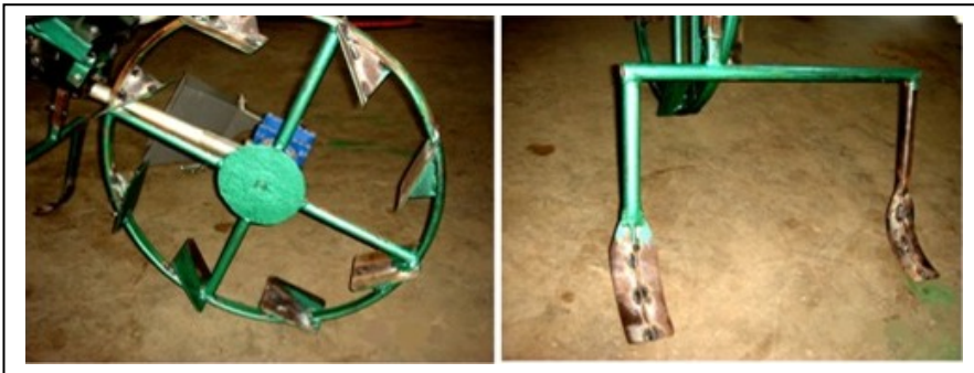
Gambar 3. Proses fabrikasi komponen penakar pupuk (metering device)
