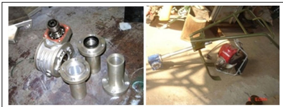
Gambar 5. Proses fabrikasi komponen reduction gear
