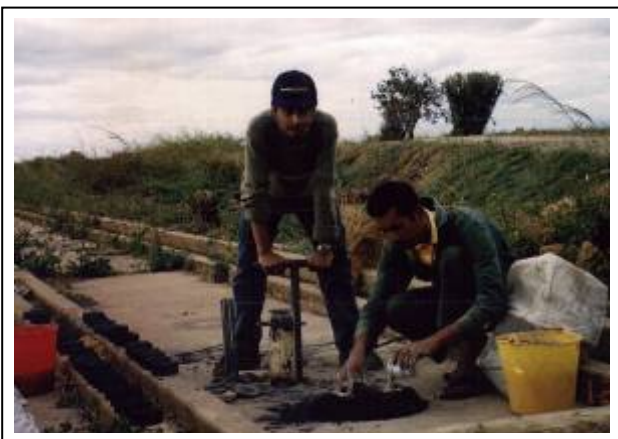
Gambar 15-16. Pencetak briket arang sekam terbuat dari besi dengan 4 komponen utama yaitu : a). besi landasan dilengkapi besi beton (CRS) \Phi 12 mm yang di las vertikal terhadap landasan sebanyak 5 buah dipasang simetris; b). pipa penutup \neq 5 mm dan \Phi 150 mm dilengkapi dengan pegangan kiri dan kanan; c). tuas penekan terbuat dari pipa \Phi 25 mm berbentuk "T" dan di bagian bawah dipasang plat besi lingkaran ( flange/ring ) \neq 5 mm dengan 5 buah lubang \Phi 13 mm; dan d). 4 buah plat besi berbentuk lingkaran juga dengan 5 buah lubang \Phi 13 mm.
