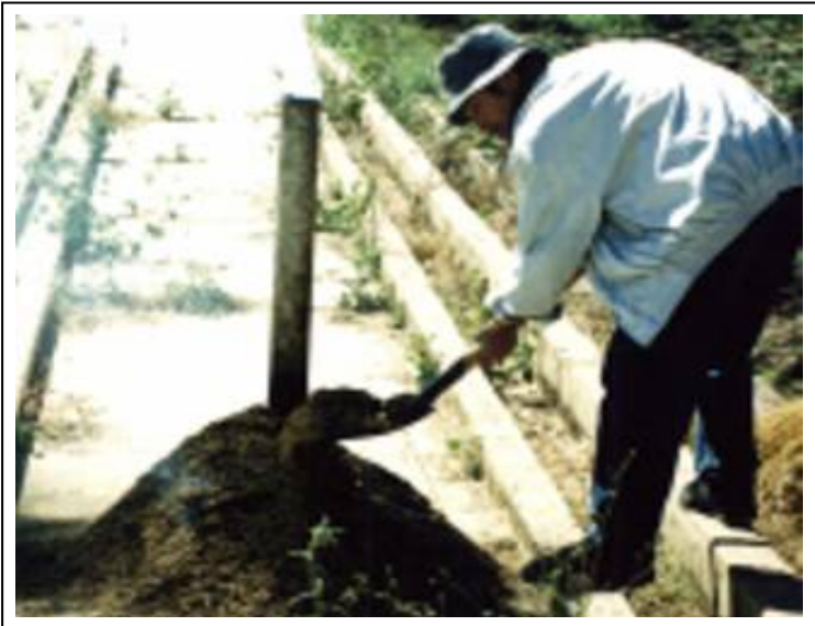
Gambar 7-8. Lakukan pembalikan pada sekam menggunakan sekop untuk menghindari over-heating sehingga hasil yang diperoleh bukan arang sekam tetapi abu.
