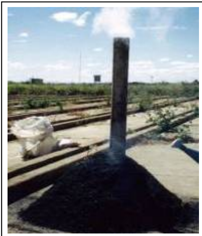
Gambar 9-10. Setelah sekam merata berwarna hitam (atas kiri), gulingkan kompor dengan mendorong pipa cerobong. Siapkan air di seboran ( shower ), atas kanan.
