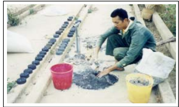
Gambar 14. Buat adonan bahan briket arang sekam yang terdiri dari arang sekam : lempung : air dengan perbandingan 3 : 1 : 2. Buat adonan sehomogen mungkin.
