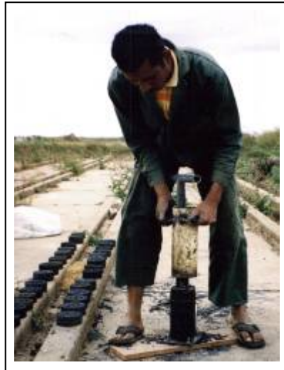
Gambar 19-21. Tekan tumpukan adonan dalam pipa dengan tuas penekan sekuat mungkin atau sambil dipujulkan. Setelah dirasa cukup padat, dengan tuas penekan tetap terpasang, tarik pipa ke arah atas. Setelah pipa terlepas, angkat ke atas ring pembatas adonan satu per satu dengan hati hati agar tidak rusak. Taruh hasilnya di tempat yang datar dan kena sinar matahari untuk dikeringkan dengan cara mendorong briket yang masih
