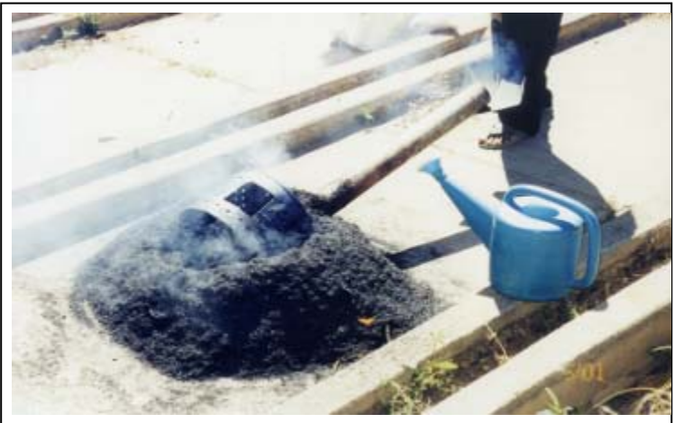
Gambar 9-10. Setelah sekam merata berwarna hitam (atas kiri), gulingkan kompor dengan mendorong pipa cerobong. Siapkan air di seboran ( shower ), atas kanan.
