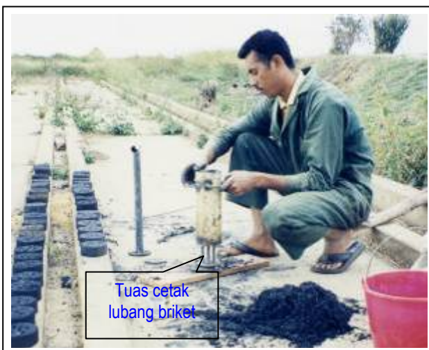
Gambar 17-18. Pasang pipa pada landasan kemudian masukkan ring pertama dan tuangkan adonan 2-3 kaleng susu kental dan ratakan dengan baik permukaannya di dalam pipa dan padatkan dengan tuas penekan. Kemudian pasang ring yang kedua diatas adonan pertama dan isi lagi dengan adonan, demikian seterusnya sampai ring yang keempat terpasang.
