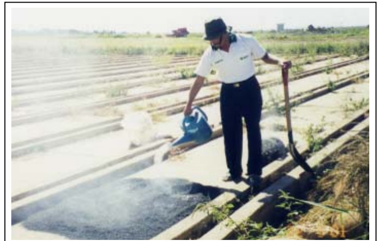
Gambar 11-12. Ratakan arang sekam ke permukaan tanah atau lantai semen dengan ketebalan 3-5 cm sambil disiram air untuk mematikan bara api pada arang sekam agar arang sekam tidak menjadi abu dan kemudian biarkan kering oleh sinar matahari. Aetelah kering masukkan dalam karung plastik untuk disimpan atau siap digunakan langsung pada tungku arang sekam maupun dicetak menjadi briket arang sekam.
