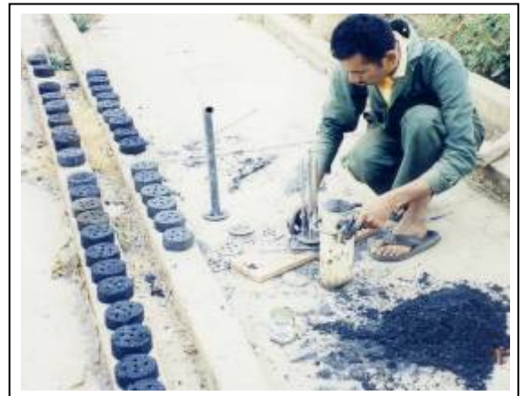
Gambar 15-16. Pencetak briket arang sekam terbuat dari besi dengan 4 komponen utama yaitu : a). besi landasan dilengkapi besi beton (CRS) \Phi 12 mm yang di las vertikal terhadap landasan sebanyak 5 buah dipasang simetris; b). pipa penutup \neq 5 mm dan \Phi 150 mm dilengkapi dengan pegangan kiri dan kanan; c). tuas penekan terbuat dari pipa \Phi 25 mm berbentuk "T" dan di bagian bawah dipasang plat besi lingkaran ( flange/ring ) \neq 5 mm dengan 5 buah lubang \Phi 13 mm; dan d). 4 buah plat besi berbentuk lingkaran juga dengan 5 buah lubang \Phi 13 mm.
