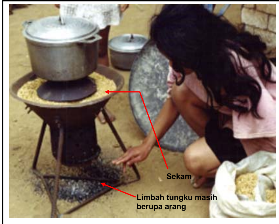
Gambar 1. Memanfaatkan sekam langsung untuk bahan bakar tungku hasil pemanasannya tidak efisien karena energi panas digunakan untuk mengubah sekam menjadi arang dan menguap berupa asap (1). Oleh karena itu dianjurkan sekam dikonversi terlebih dahulu menjadi arang sekam yang memiliki nilai kalori panas jauh lebih tinggi dibandingkan sekam (2).
