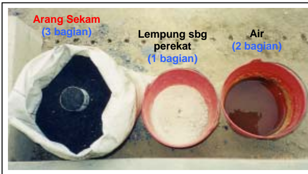
Gambar 13. Untuk membuat briket arang sekam, siapkan alat pencetak briket sederhana, lempung dan air.
