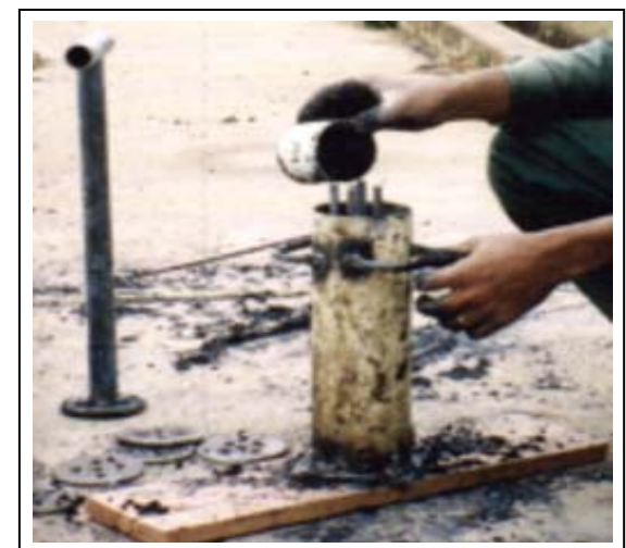
Gambar 17-18. Pasang pipa pada landasan kemudian masukkan ring pertama dan tuangkan adonan 2-3 kaleng susu kental dan ratakan dengan baik permukaannya di dalam pipa dan padatkan dengan tuas penekan. Kemudian pasang ring yang kedua diatas adonan pertama dan isi lagi dengan adonan, demikian seterusnya sampai ring yang keempat terpasang.
