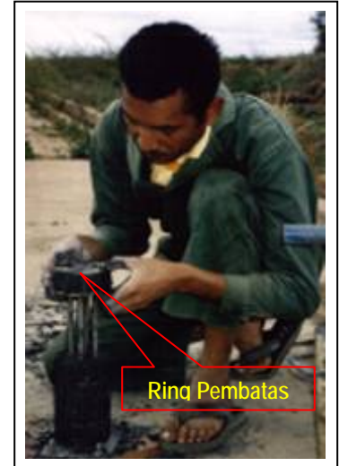
Gambar 19-21. Tekan tumpukan adonan dalam pipa dengan tuas penekan sekuat mungkin atau sambil dipujulkan. Setelah dirasa cukup padat, dengan tuas penekan tetap terpasang, tarik pipa ke arah atas. Setelah pipa terlepas, angkat ke atas ring pembatas adonan satu per satu dengan hati hati agar tidak rusak. Taruh hasilnya di tempat yang datar dan kena sinar matahari untuk dikeringkan dengan cara mendorong briket yang masih
