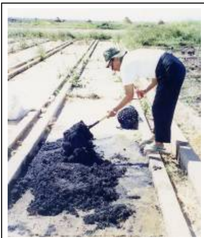
Gambar 11-12. Ratakan arang sekam ke permukaan tanah atau lantai semen dengan ketebalan 3-5 cm sambil disiram air untuk mematikan bara api pada arang sekam agar arang sekam tidak menjadi abu dan kemudian biarkan kering oleh sinar matahari. Aetelah kering masukkan dalam karung plastik untuk disimpan atau siap digunakan langsung pada tungku arang sekam maupun dicetak menjadi briket arang sekam.
