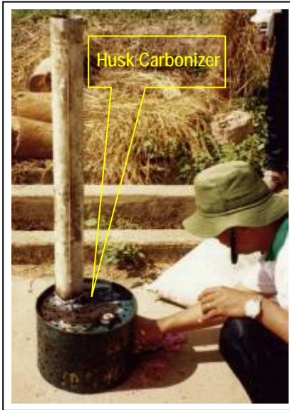
Gambar 3. Pembakaran awal menggunakan limbah kayu atau kertas dll di ruang bakar
