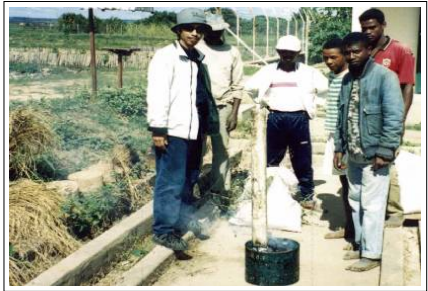
Gambar 4. Biarkan limbah dalam ruang bakar menyala sempurna yang ditandai dengan berkurangnya asap yang keluar dari lubang ruang bakar atau cerobong.
